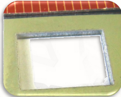
Подложка: поликор 1 мм, Покрытие: тантал 10 мкм
