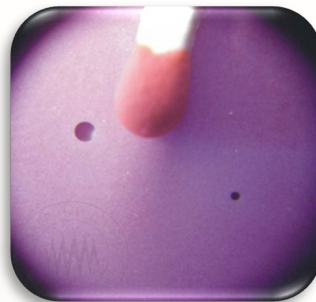
Корундовая керамика 1 мм, отверстия 50 и 100 мкм
