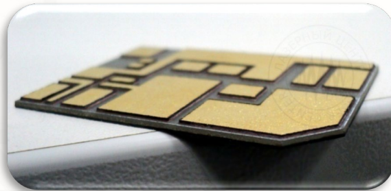
Подложка: нитрид алюминия 1,5 мм, Пок­ры­тие: медь 300 мкм
