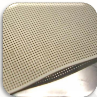
Низкотемпературная керамика (LTCC) 1 мм, отверстия 50 мкм
