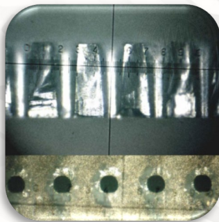
Кремний 0,5 мм, отверстия с конусностью 70-100 мкм
