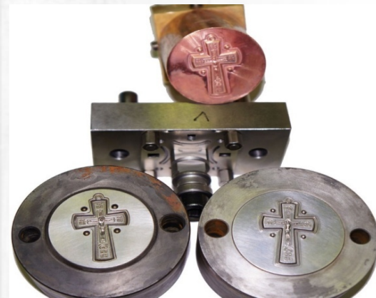
Электроискровая прошивка, ручная доработка
